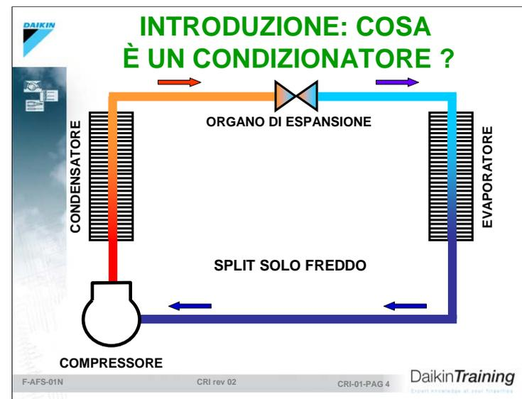
Il condizionatore raffredda l'aria utilizzando lo stesso principio di funzionamento e gli stessi componenti che si possono ritrovare anche nel frigorifero di casa:
